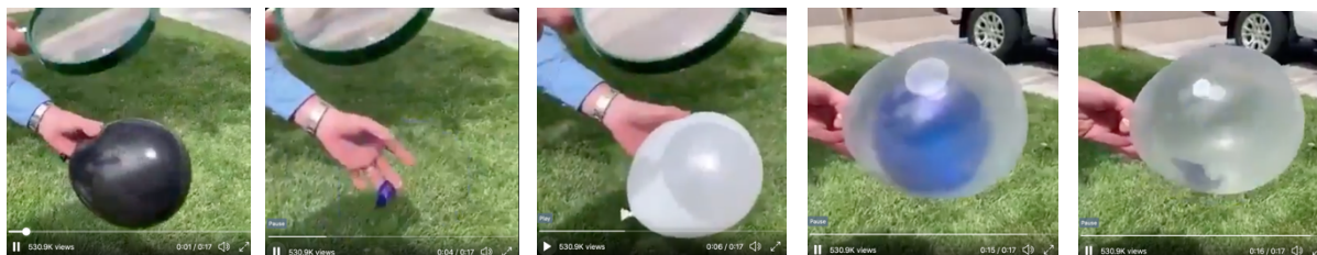
Слика 3 Експерименти са зрачењем – бела боја апсорбује мање светлости и мање топлоте
