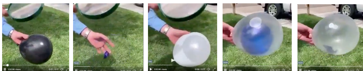
Fig. 3 Experimentos de radiación: el color blanco absorbe menos luz y menos calor
